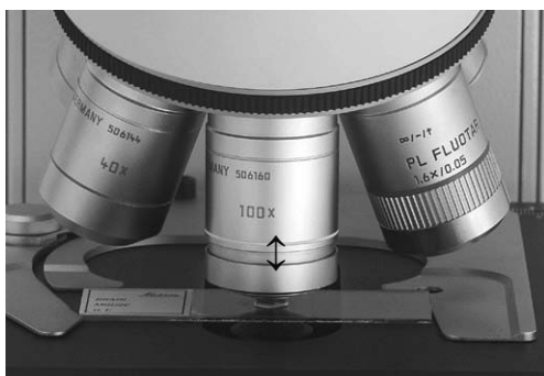
Fig. 63a Objectif à immersion (déverrouillé)
