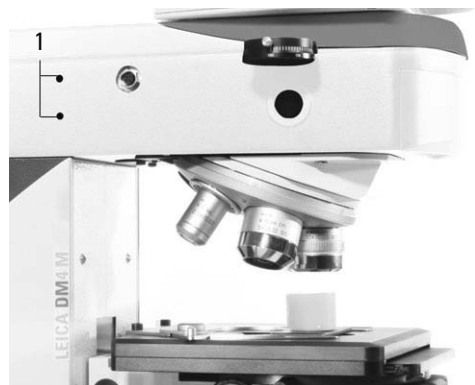
Abb. 42b Justierung der Aperturblende in der Auflichtachse 1 Justierschrauben für Verschiebung der Aperturblende
