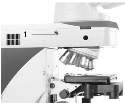
Fig. 10 Connexion du tube motorisé 1 Fiche de connexion
