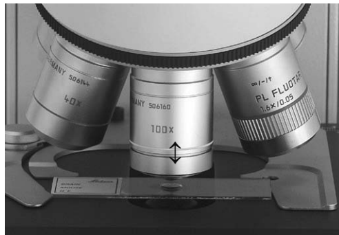
Fig. 63b Objectif à immersion (verrouillé)
