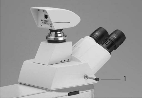
Fig. 62 Tube BDT25+ avec caméra numérique
