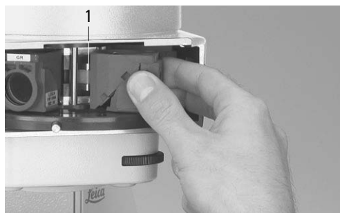
Fig. 26 Insertion du bloc de filtres ou du réflecteur 1 Support
