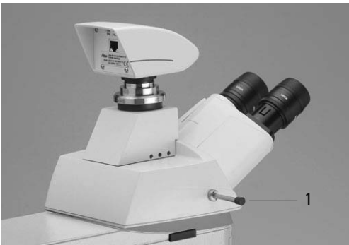
Abb. 62 Tubus BDT25+ mit Digitalkamera
