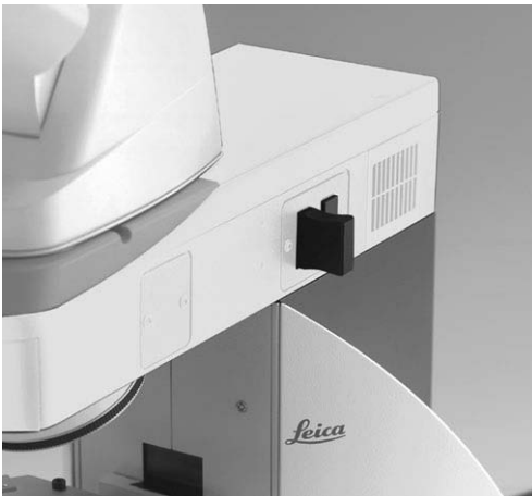
Abb. 75 Einsetzen der Booster-Linse
