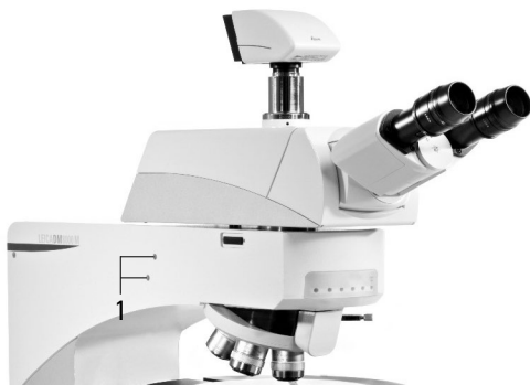
Fig. 30 Ajustement du diaphragme d'ouverture dans l'axe de la lumière incidente
