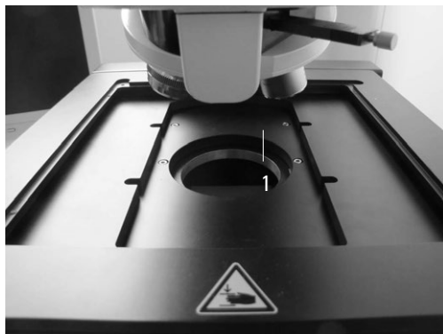
Fig. 20 Montage de l'éclairage IR
