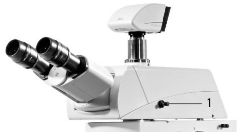
Fig. 43 Division du faisceau lumineux sur le tube 1 Tige de réglage
