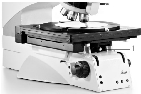
Fig. 32 Réglage en hauteur du condenseur
