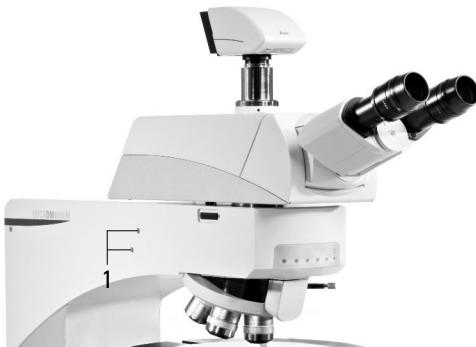
Abb. 30 Justierung der Aperturblende in der Auflichtachse 1 Justierschrauben für Verschiebung der Aperturblende
