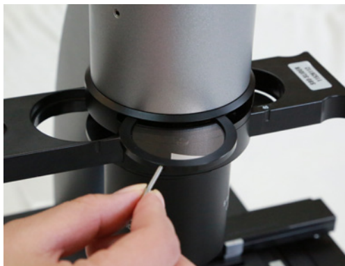
Fig. 9 Insert du filtre de diascopie
