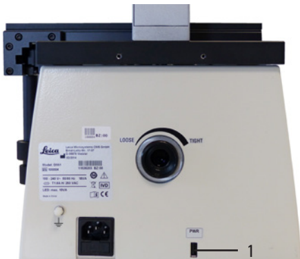
Abb. 9 Stativrückseite 1 Stromversorgung für Kamera
