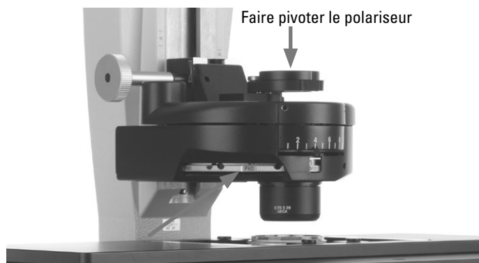
Réglage du condenseur avec bras basculant d'éclairage par lumière transmise – réglage du prisme de Wollaston
