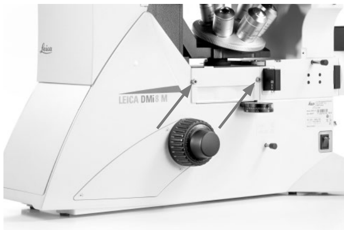
Vis de fixation du couvercle de la tourelle porte-rélecteurs
