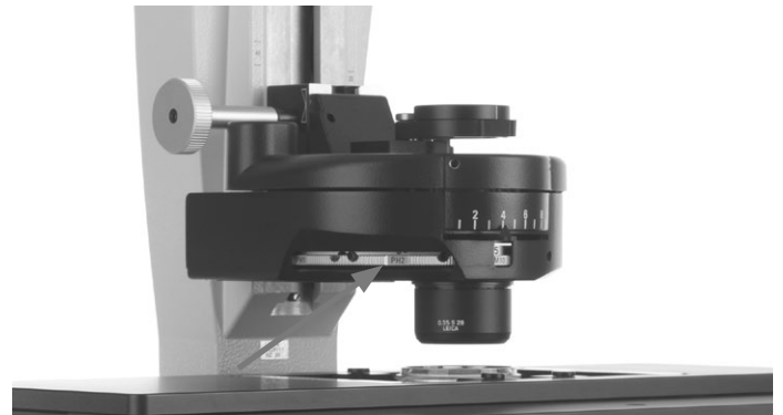
Kondensoreinstellung bei kippbarem Durchlicht-Beleuchtungsarm - Dunkelfeldstopp (Lichtring) einstellen
