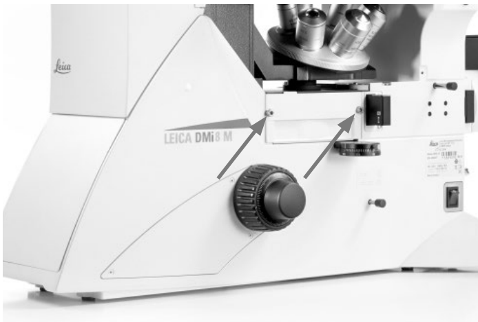
Schrauben zur Sicherung der Reflektorrevolverabdeckung
