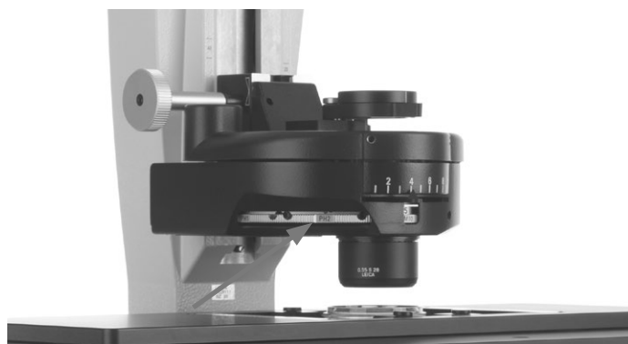
Réglage du condenseur avec bras basculant d'éclairage par lumière transmise – réglage de l'anneau fond noir (anneau de lumière)
