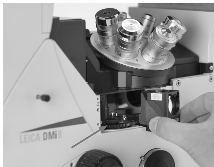
Position vide pour logement d'un bloc de réflecteur. Le bloc de réflecteur est introduit de face jusqu'à l'enclenchement.
