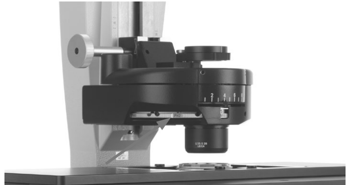
Kondensoreinstellung bei kippbarem Durchlicht-Beleuchtungsarm - Position BF einstellen
