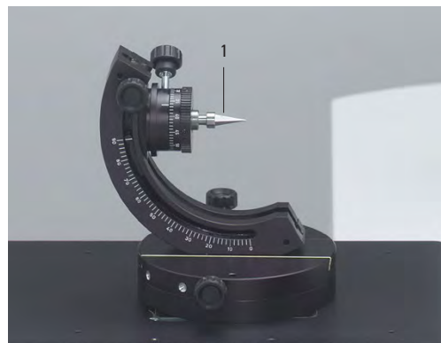
Fig. 41 Support amovible avec logement convexe pour munitions d'arme à air comprimé
