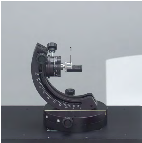
Fig. 39 Support amovible avec logement pour projectiles déformés
