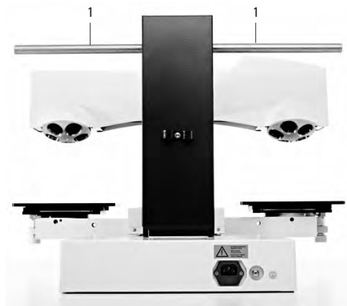
Fig. 1 Statif pourvu de poignées 1 Poignée dévissable
