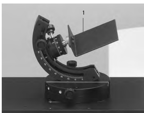
Abb. 45 Verstellbarer Halter mit Aufnahme für Schließzylinder
