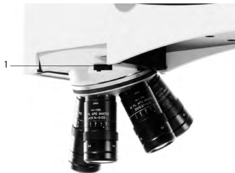
Fig. 55 Tourelle porte-objectifs équipée
