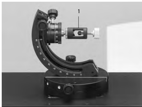
Abb. 45 Verstellbarer Halter mit Aufnahme für Schließzylinder
