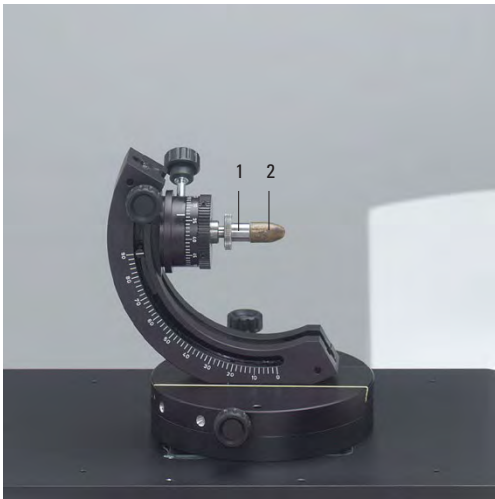
Fig. 38 Support amovible avec cylindre de masticage pour projectiles
