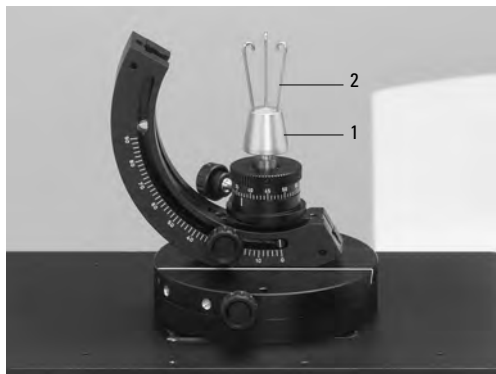
Abb. 43 Verstellbarer Halter mit Jagdpatronenhalter
