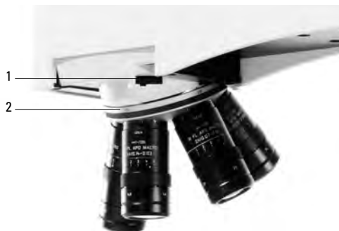
Abb. 5 Objektivrevolver mit Objektiven
