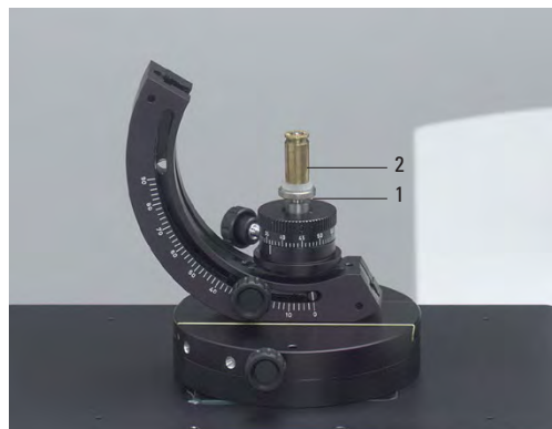
Fig. 40 Support amovible avec logement convexe pour douilles de cartouches
