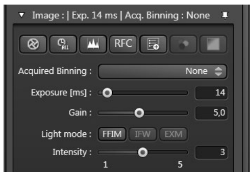
Fig. 5 : réglage de la transmission pour FFIM
