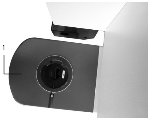
Fig. 4 Couvercle du statif 1 Filtre de protection
