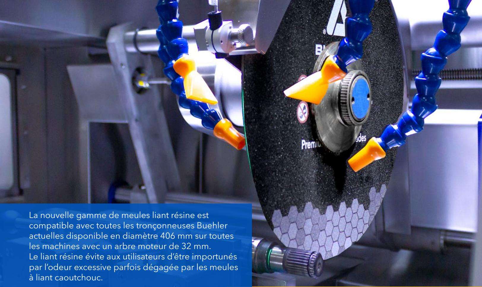
La nouvelle gamme de meules liant résine est compatible avec toutes les tronçonneuses Buehler actuelles disponible en diamètre 406 mm sur toutes les machines avec un arbre moteur de 32 mm. Le liant résine évite aux utilisateurs d'être importunés par l'odeur excessive parfois dégagée par les meules à liant caoutchouc.
