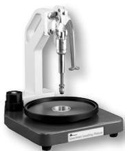
Utilisé pour charger les portes-échantillons à pression centrale pour garantir des échantillons à plat.
