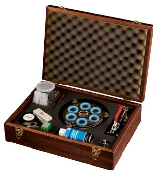
Ce système de préparation est conçu pour les circuits imprimés en coupe transversale avec via revêtus de cuivre. Le porte échantillon peut préparer jusqu'à 36 coupes en même temps, 25 mm de long dans six moules distincts. Cet accessoire permet de contrôler les revêtements sur chaque via de diamètre jusqu'à 200µm en coupe transversale précise et reproductible. Adaptateur d'entraînement à pression centrale requise (60-9000) vendu séparément.
