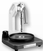
Utilisé pour charger les porte-échantillons à pression centrale pour garantir des échantillons à plat.
