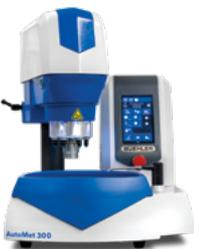
L'AutoMet 300 Pro est similaire à l'AutoMet 250 Pro, avec un moteur amélioré et un plateau de plus grande taille pour accueillir des échantillons plus importants. Elle est également compatible avec des accessoires comme PC-Met et PWB Met pour le polissage des circuits imprimés.
