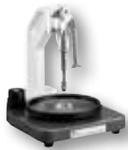
Utilisés pour le chargement des porte-échantillons en pression centrale afin d'assurer la planéité des échantillons.
