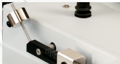
Leur position en dehors de la chambre de coupe facilite l'utilisation des commandes du bras à poids et du micromètre.
