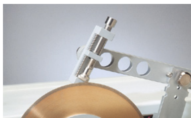
Le support de bridage 11-2482 facilite la coupe longitudinale de boulons.
