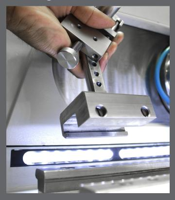
Le système Rapid Rail de Buehler permet aux utilisateurs de sécuriser les échantillons dans la chambre de coupe et de commencer la coupe suivante en quelques secondes.
