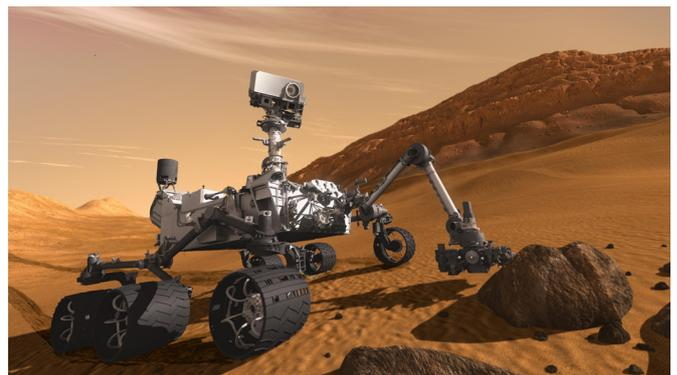
Le rover Curiosity est équipé d'un analyseur de spectre LIBS, l'image a été fournie par NASA/JPL-Caltech
