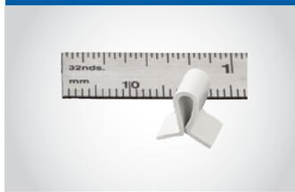
Support trépied en plastique idéale pour les résines d'enrobage à froid.\*
